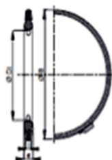
Arruela com alma metálica moldada e dispositivo de apoio DN 350 a DN 1200
