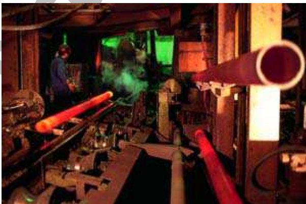
Fabricação de tubos SMU
