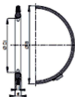
Arruela com alma metálica moldada e dispositivo de apoio DN 350 a DN 1200
